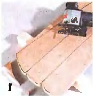
1 «Занавес» выкраивают из ДСП ножовкой по размеченным карандашом контурам.
