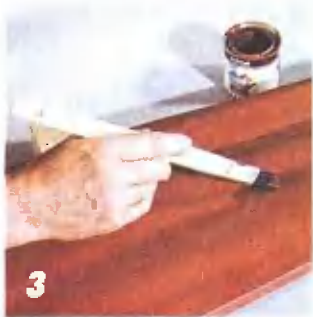
3 Акриловую краску наносят кистью-флейцем. По линии складок краску наносят гуще, «разгоняя» затем ее по сторонам.
