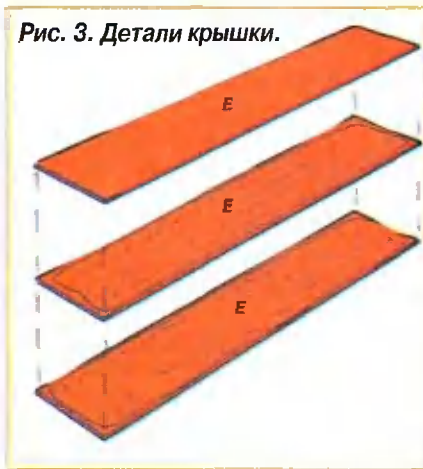
2 Чтобы детали легче гнулись, их смачивают водой.
