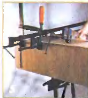
Пока не затвердел клей и не затянуты окончательно струбцины, можно еще проверить, правильно ли совпали фасадные детали.
