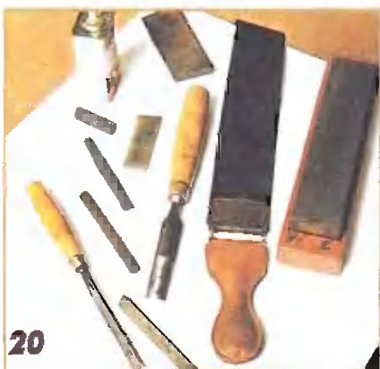
20 Базовая оснастка для резьбы по дереву: полукруглая стамеска, рейсмус, фасонные абразивные бруски соответствующей формы, оселок, ремень для доводки и масло.
