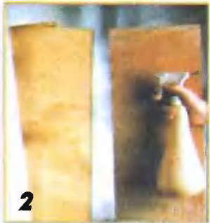
2 Чтобы детали легче гнулись, их смачивают водой.
