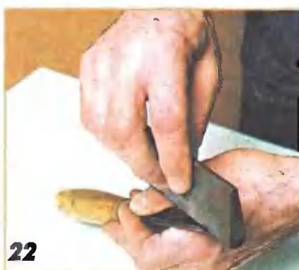
22 Изнутри полукруглую стамеску затачивают фасонным абразивным бруском, форма которого соответствует профилю инструмента. При заточке совершают бруском движения в направлении режущей кромки.
