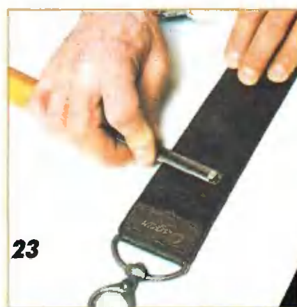
23 Чтобы удалить заусенец, образовавшийся на режущей кромке при заточке на абразивном бруске, производят доводку инструмента на кожаном ремне.
