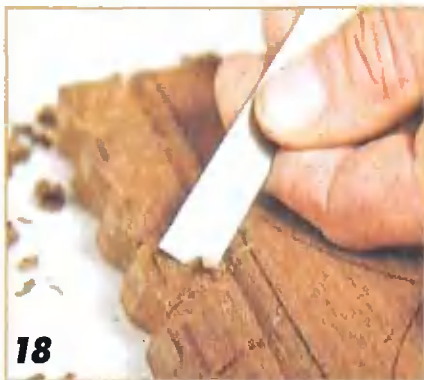
18 Стамеской с косым лезвием делают «витки» узора пластичными. Инструмент держат так, чтобы его лезвие было направлено в сторону края заготовки.
