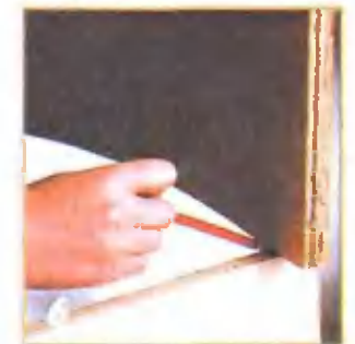
Разметка угла скоса на кромке боковой стенки и линии выступа верхнего щита за пределы боковой стенки.
