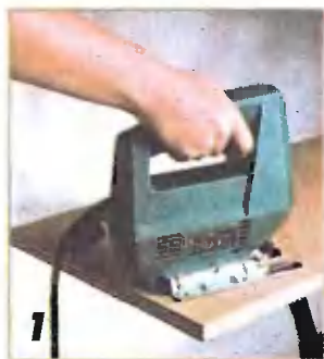
Скругляют передние кромки полок и днищ выдвижных ящиков электролобзиком.
